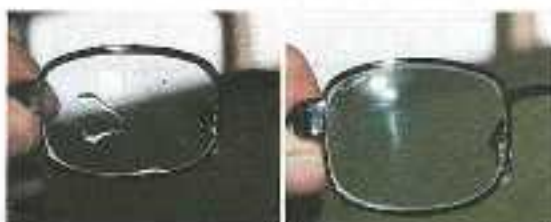
Gambar12. lensa dengan bahan kaca sebelum dan sesudah proses pembersihan dengan timer 5menit dan frekuensi 100Hz
