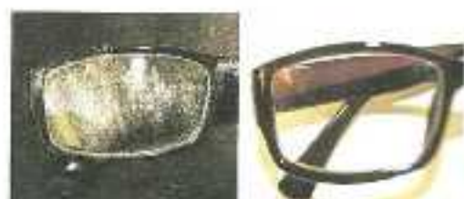
Gambar 9. lensa dengan bahan mika sebelum dan sesudah proses pembersihan dengan timer 5menit dan frekuensi 50Hz
